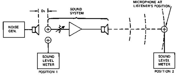
SYSTEM GAIN = LEVEL, POSITION 2, SYSTEM ON — LEVEL, POSITION 2, SYSTEM OFF SYSTEM  $\Delta$  = LEVEL, POSITION 2, SYSTEM ON — LEVEL, POSITION 1, SYSTEM OFF
